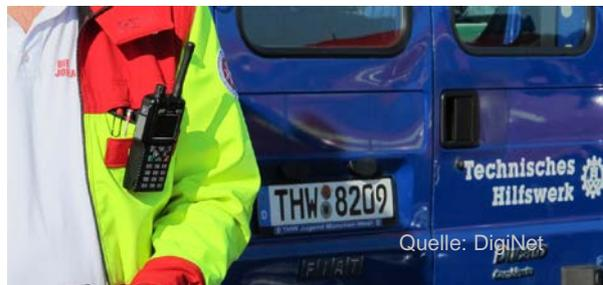
ums des Innern führen die Autos in fünf Durchgängen die Rollbahn auf und ab. Dabei wurde die Funklast schrittweise auf bis zu acht Sprechgruppen einschließlich Datenversand SDS (*short data service*; entspricht den SMS im Mobilfunk) gleichzeitig gesteigert und die Testansagen von den Einsatzkräften im Hinblick auf Sprachqualität und Vollständigkeit geprüft. Die Auswertungen der Tests sind noch nicht abgeschlossen, ein erstes Fazit jedoch bereits möglich:
