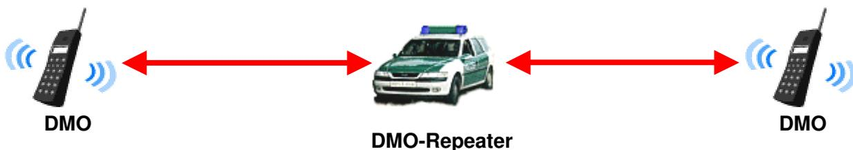
Ein digitales Funkgerät mit zusätzlicher Repeater-Funktion (z. B. in einem Einsatzfahrzeug oder Hubschrauber) agiert zwischen verschiedenen Handfunkgeräten im DMO-Betrieb. Diese können über den Repeater (vergleichbar mit einer Relaisfunkstelle im Analogfunk) miteinander kommunizieren. Mit Hilfe des Repeaters kann der Abstand zwischen den Handfunkgeräten im DMO deutlich erweitert werden.
